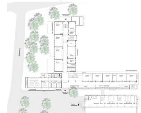
Das alte Grundschulgebäude von 1937 wurde grundlegend saniert. Teile des Erdgeschosses wurden für eine Pausenhalle abgesenkt und zum Schulhof hin geöffnet.
